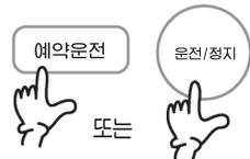
**참조** • 예약운전은 예약운전 표시램프 및 자동운전 표시램프와 연소시간 “1시간” 표시 램프가 켜진 상태에서 점화되며 사람이 부재중일 때의 안전에 대비하여 1시간 동안 연소 후 자동으로 꺼집니다.
